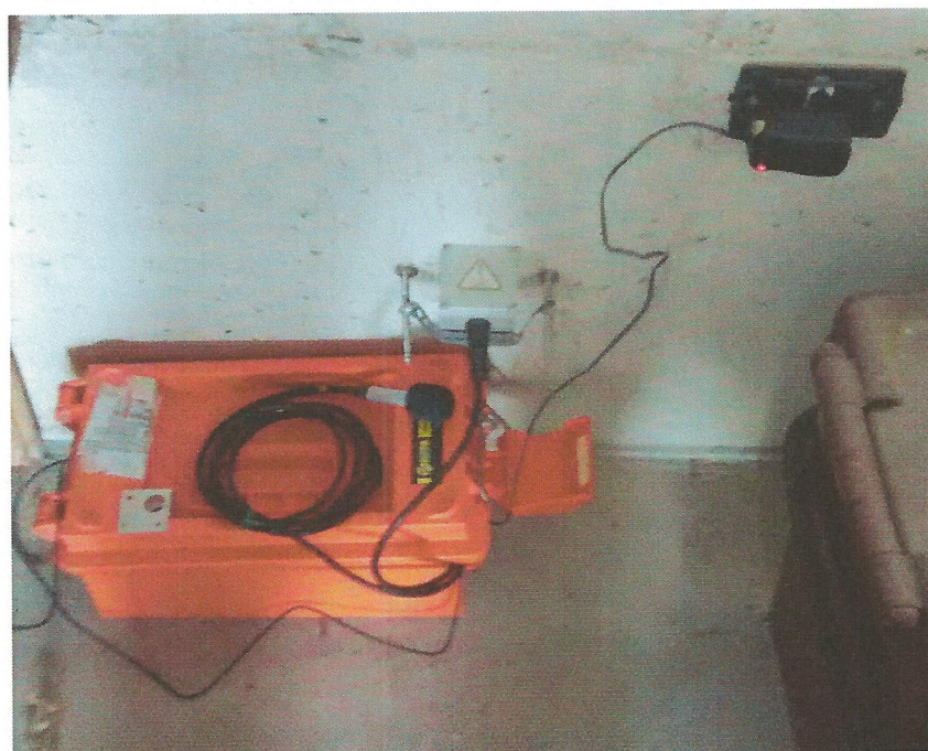
Installazione del trasduttore di velocità triassiale.
