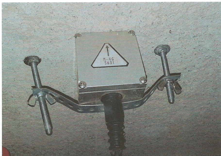
Installazione del trasduttore di velocità triassiale.
